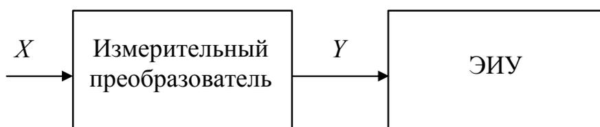
Рис. 4.1 Универсальная схема прибора для измерения неэлектрических величин
