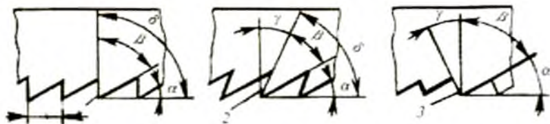
15-расм. Арра полотноси тишларининг бурчаклари
