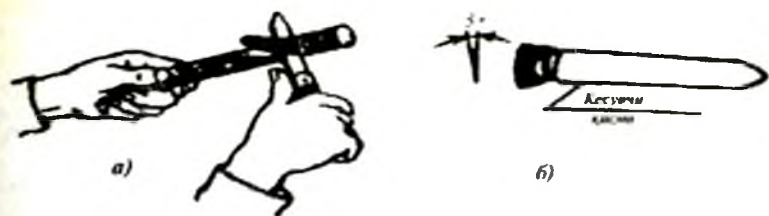
2-расм. Пичоқнинг кесувчи қисми (а) ва қиринди ажралиб чиқлиши (б).
