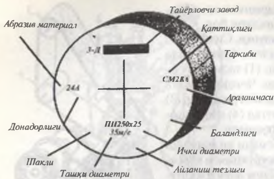
176-расм. Силлиқлаш тошининг тамғаси.
