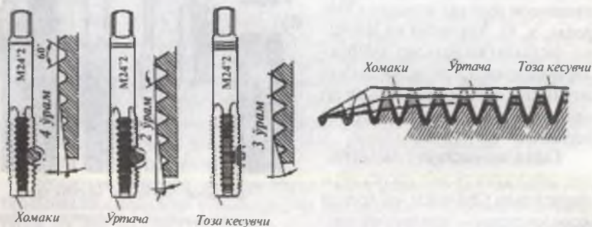
263-расм. Метчиклар тўплами.
