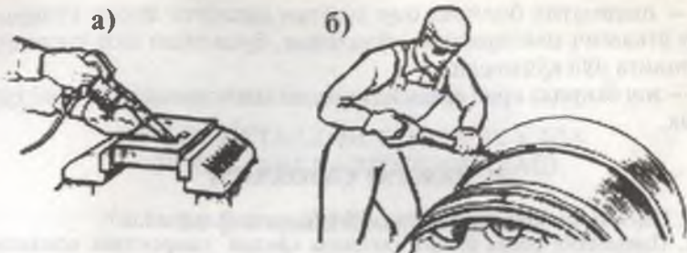
79-расм. Қирқувчи болғани ушлаш (а) ва у билан ишлаш (б).
