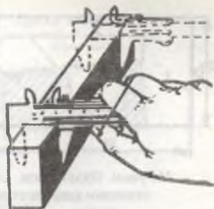
154-расм. Эговланган юзалаarning параллеллигини штангенциркуль билан текшириш.
