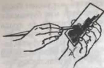
44-расм. Заготовкаиға буюқ суркаш.
