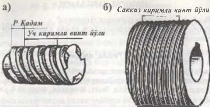
259-расм. Қиримлар сони бўйича резьба турлари: а—уч қиримли; б—саккиз қиримли.
