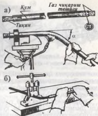
102-расм. Қувурни қиздириб эгиш: а—андоза буйича; б—қувурга қисиб.
