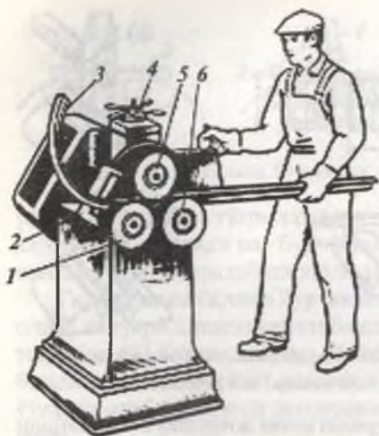
100-расм. Уч роликли дастгоҳда эгри профилларни эгиш.
