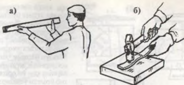
82-расм. Тасма материалнинг эгрилигини текшириш (а) ва тўғрилаш (б).
