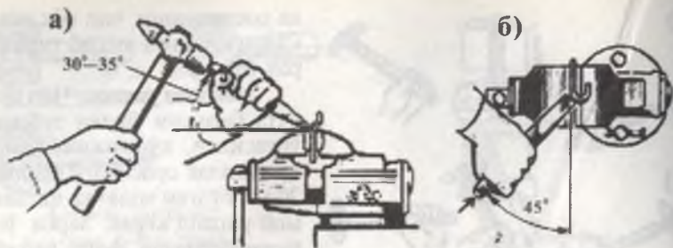
68-расм. Гирада кесишда зубилони ўрнатиш: ишлов берилдиган сиртга (а) ва гира қўндаланг уқига (б) зубилонинг қиялиги.
