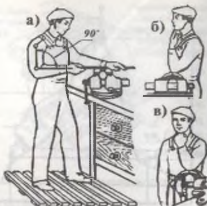
22-расм. Гираларни ўрнатиш баландлиги: а—эговлашда; б, в—металл қирқишда.
