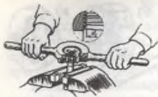
272-расм. Плашка билан резъба кесиш усуллари.
