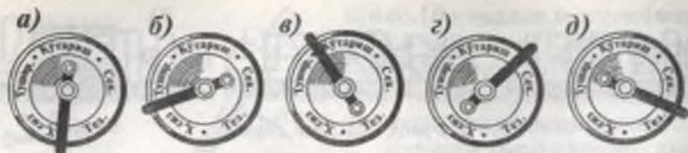
130-расм. Дастанинг ҳолати: а—ҳаракатсиз; б—тушириш; в—кутариш; г—секин ҳаракат; д—тез ҳаракат.
