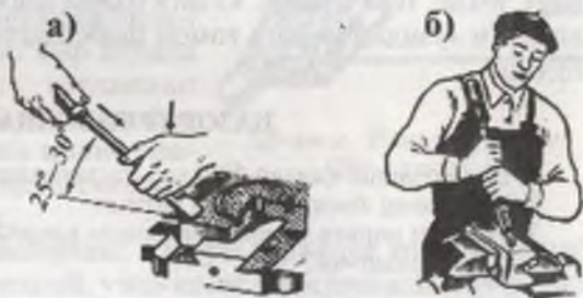
323-расм. Шаберлаш усуллари: а—ўзидан нари ва б—ўзига томон.
