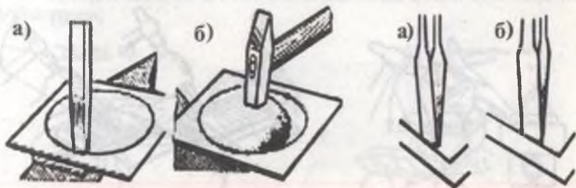
71-расм. Листли заготовкани қирқиш:
