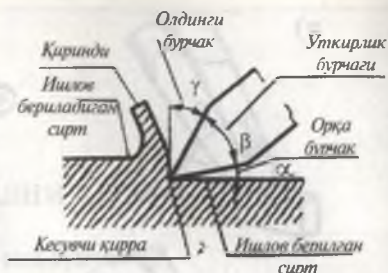
57-расм. Кесиш элементлари ва зубило кесувчи қисмининг геометрияси.
