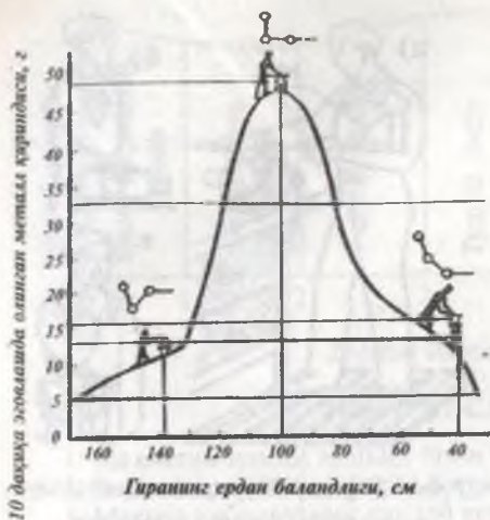
20-расм. Гира баландлигининг меҳнат унумдорлигига таъсири.
