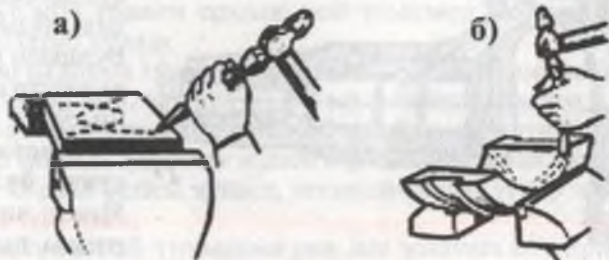
76-расм. Мойлаш ариқчаси ва ўйиқларни кесиш: а—ясси сирт; б—ботиқ сирт.
