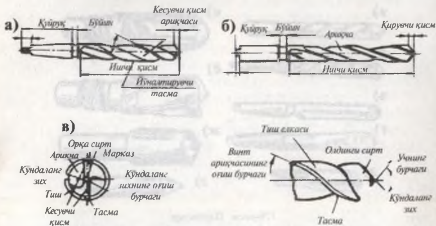
180-расм. Спирал парма (а, б) ва унинг элементлари (в).
