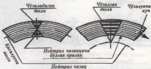
93-расм. Эгилган заготовкада кучланиш схемаси.
