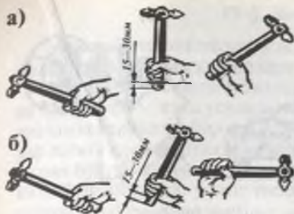
66-расм. Болгани сиқмасдан (а) ва сиқиб (б) ушлаш.
