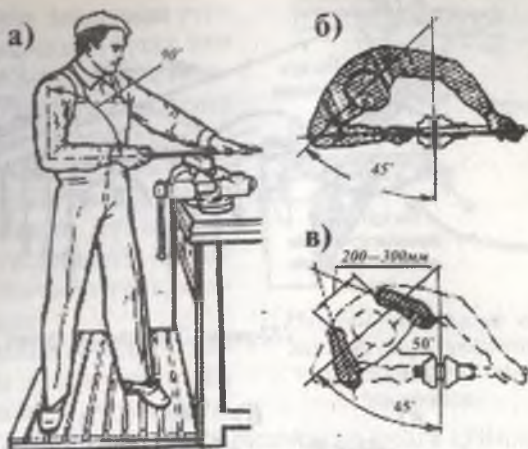
150-расм. Эговлашда қўл (а), гавда (б) ва оёқнинг (в) ҳолати.
