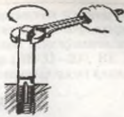
279-расм. Синган метчикни калит ёрдамида чиқариш.
