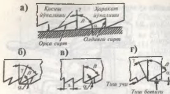
118-расм. Арра тишининг элементлари.
