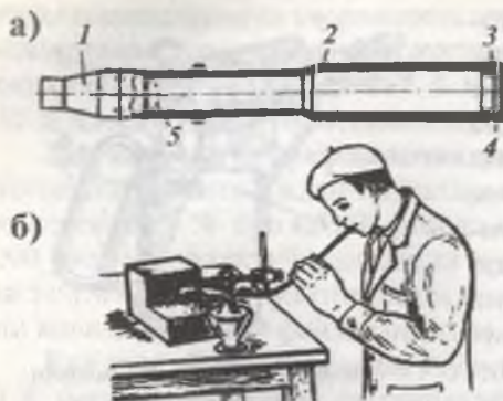
352-расм. Кичик улчамли қиздириш лампаси (а) ва ковиялаш қувурчаси (б).
