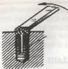
278-расм. Синган метчикни тешиктан чиқариш.
