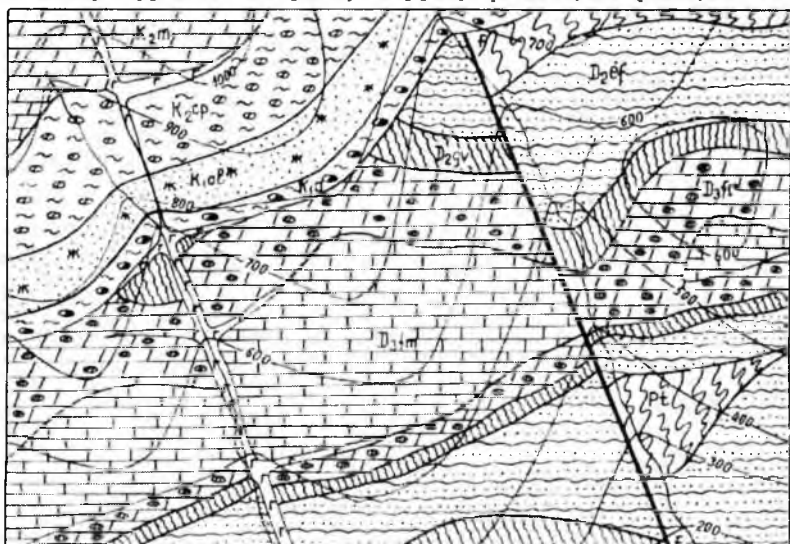
64-расм. Ер ёриқлари билан мураккаблашган синклинал ва антиклинал бўрмаларнинг геологик харитага тасвирланиши. Pt-протерозойнинг кристалланган сланецлари, D 2ef -ўрта девонэйфел яруси кварцитлари, D 2gv -живет яруси гилли сланецлари, D 3fr -юқори девон фран яруси мергеллари, D 3fm -фамен яруси битумли оҳақтошлари, K 1a -қуйи бўр апт яруси фосфоритли гиллари, K 1al -альб яруси темирли қумтошлари, K 2sp -юқори бўр компан яруси гиллари, K 2m -маастрихт яруси мергеллари.
