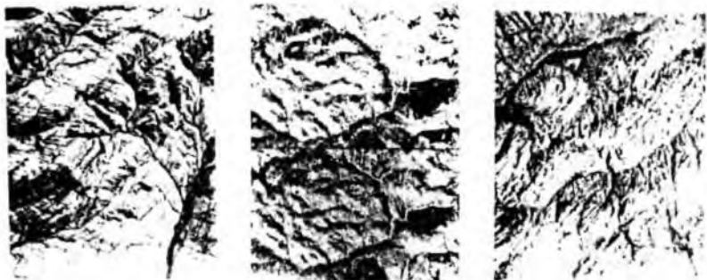
112—расм. Интрузив таналарнинг аэрофотосуратларда тасвирланиши: а—чегаралари яхши аниқланувчи гранит массиви, б—гранодиорит массивидаги устки қолдиқ (стереопара), в—параллел ёриқлар билан кесилган гранитлар.
