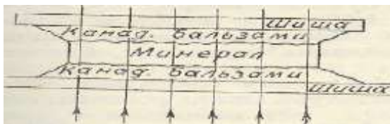
2- rasm. Shlifping ko'ndalang kesmasi: vertikal parallel chiziqlar nurlarning yunalishi
