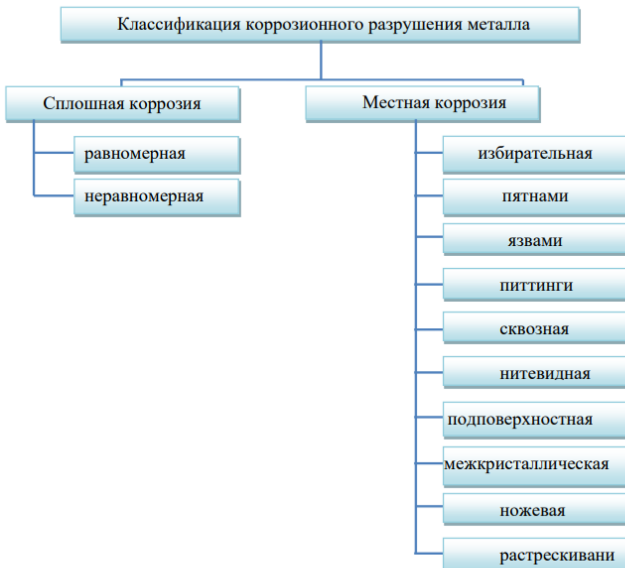
Рисунок 2 – Характер коррозионных разрушений
