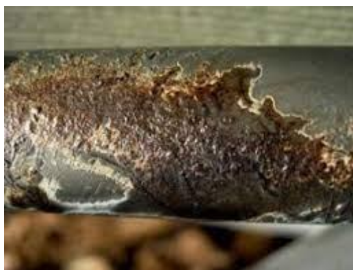
Рисунок 7 – Питтинговая коррозия алюминиевой трубы
