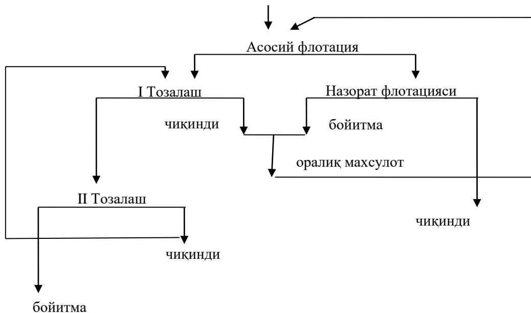
116-rasm. Boyitmani ikki marta tozalash va bitta nazorat flotatsiyali flotatsiya sxemasi.
