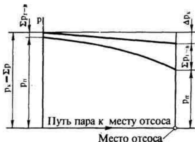
Рис. 9.5. Изменение давления в конденсаторе по мере движения пара к месту отсоса:
