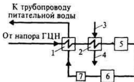
Рис. 7.14. Схема очистки реакторной воды РБМК-1000:
