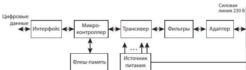
Рис. 2.15. Структурная схема PLC-модема на основе трансивера ST7538
