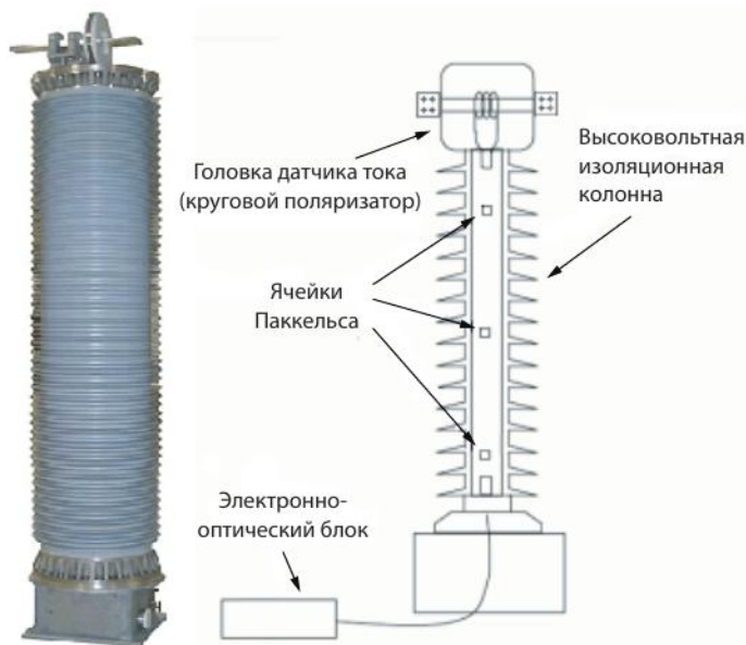
Рис. 2.42. Оптический преобразователь тока и напряжения NXVCT
