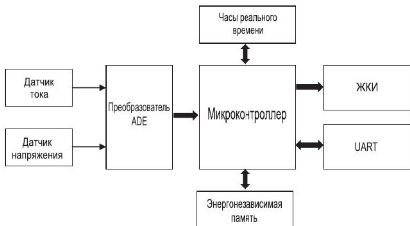
Рис. 1.6. Структурная схема однофазного счетчика ЭЭ на базе микросхем ADE
