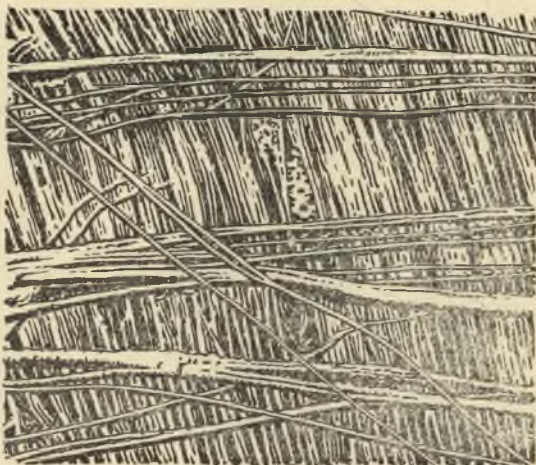
57- рasm. Целлюлоза микрофибриллаларининг ( d=100-300 \text{ \AA} ) жойланиши (электрон микроскопда 25000 марта каттала итирилган).
