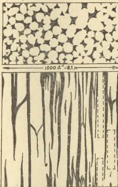
54-расм. Луб толаларидаги кўндаланг ва узунасига кесишган целлюлозанинг мицелляр тузилишининг схемаси, (Фрей Вислинг буйича) тузилиш схемаси. Мицеллалар (оқ) ва мицеллалар оралиқ бўшлиғи (қора) тўғри система ҳосил қилади; нуқтали тўғри бурчакли участка мицеллаларни кўрсатади.
