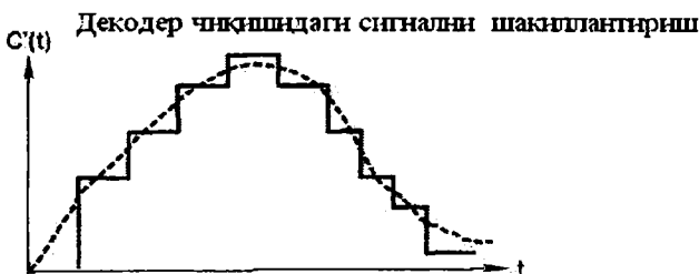
3.18-расм. ДИКМ сигнал шаклланишининг вақт бўйича диаграммалари.
