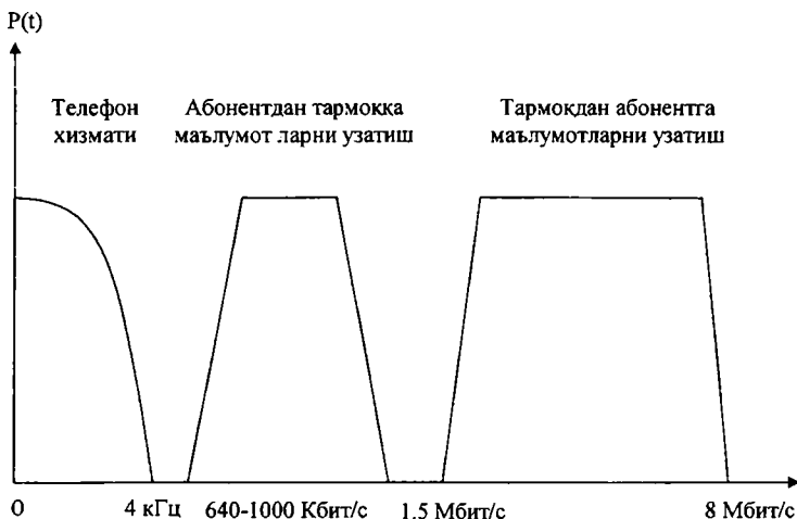
8.11-расм. ADSL курилмаларининг частота бўйича тарқалиши.
