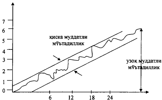
5.19-расм. Синхросигналнинг номўътадиллик графиги: қисқа ва узок муддатли номўътадиллик.
