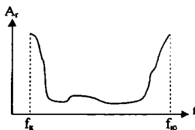
1.13-расм. Каналнинг частотавий тавсифи.
