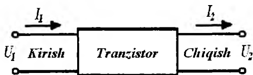
4.18-rasm. Tranzistorni chiziqli to'rt qutblik sifatida ko'rsatilishi.
