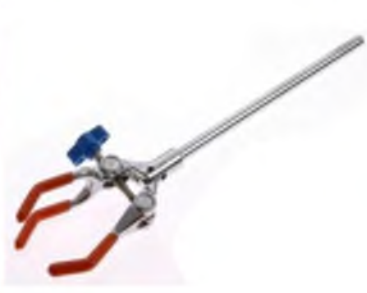
Probirka va kolbalarni mahkamlovchi qisqich
