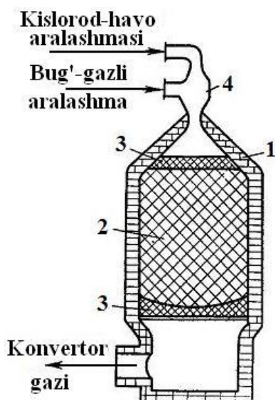
2.1-rasm. Shaxta turidagi metan konvertori sxemasi:
