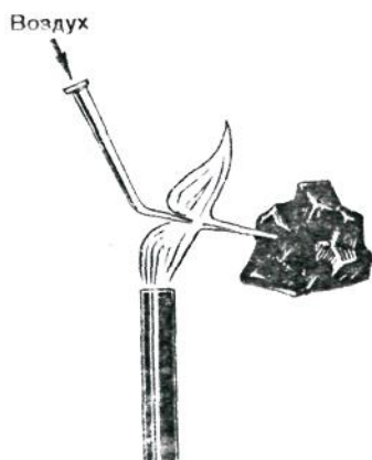
83 - rasm. Metall oksidlarini ko‘mir bo‘lakchasida qaytarish.
