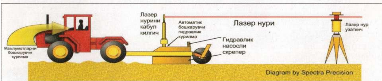
8.4–расм. Лазер нивелирида текислаш ускунасининг принципиал ишлаш схемаси ва компонентлари.
