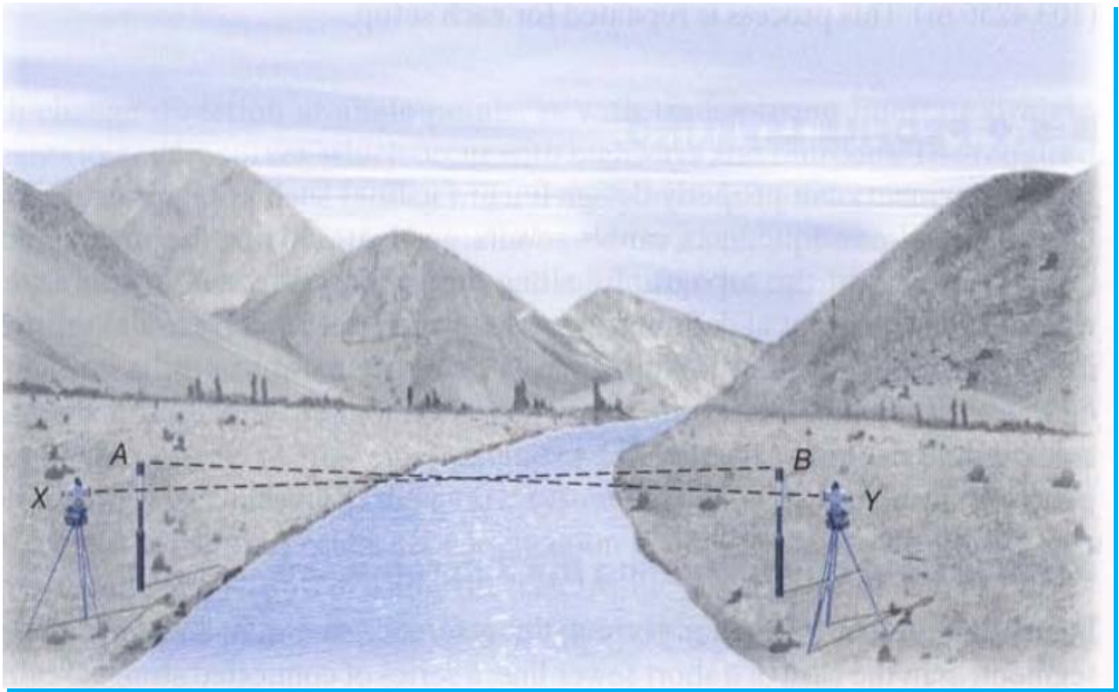
8.1-расм. Жойни дарёнинг` икки тамонидан нивелирлаш
