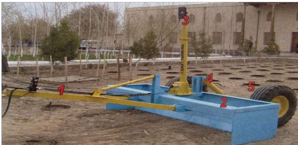
8.5–расм. Лазер текислагичнинг асосий қисмлари: 1 – тиркама рама; 2 – ковша; 3 – лазер нурини қабул қилгич ресивер учун мачта; 4 – гидротцилиндр ва шланглар; 5 – ғилдирак ва ғилдиракли рама.
