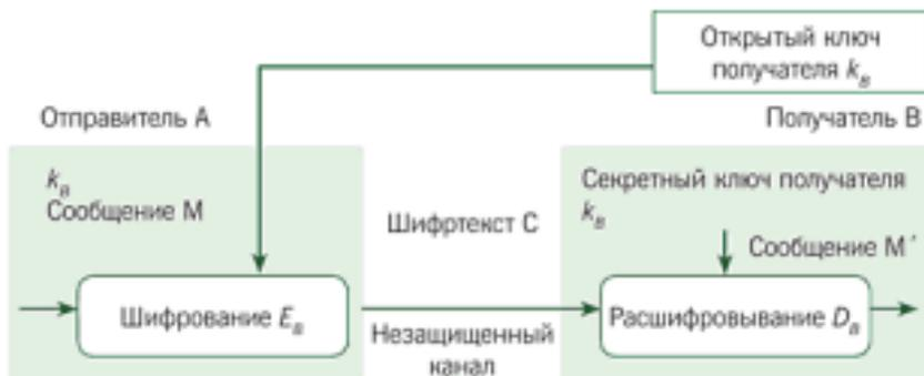
Рис. 6.2. Обобщенная схема асимметричной криптосистемы шифрования
