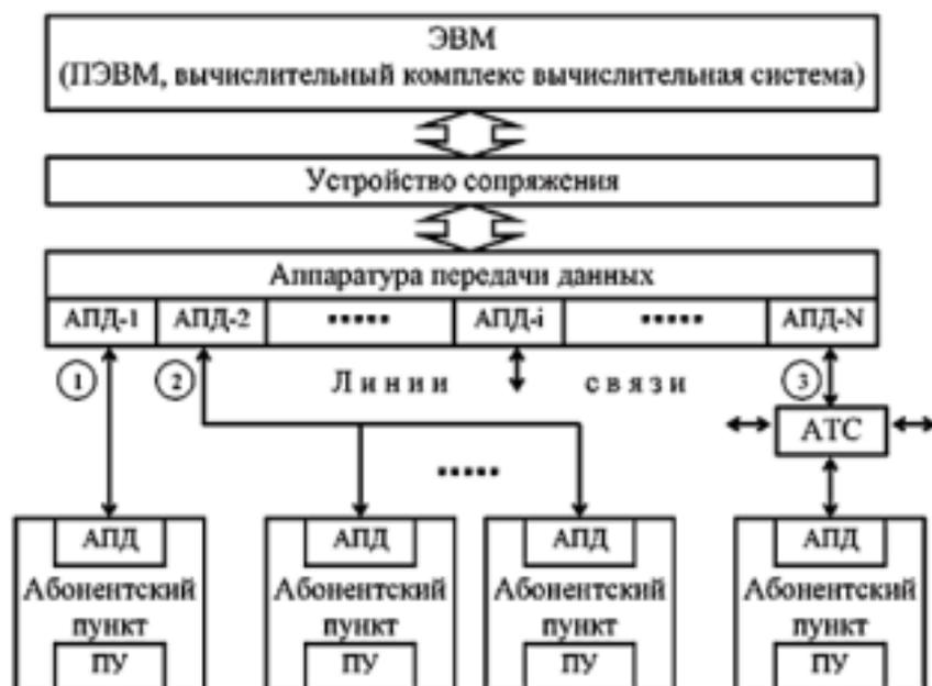
Рис. 3.5. Структура системы телеобработки данных
