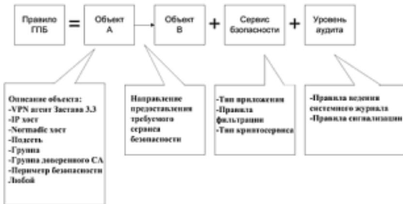
Рис. 6.5. Структура правила глобальной политики безопасности
