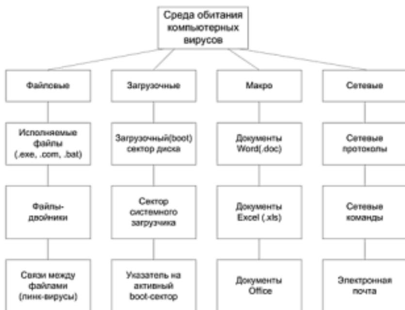
Рис. 6.4. Классификация компьютерных вирусов по среде обитания
