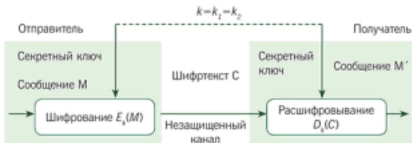
Рис. 6.1. Схема симметричной криптосистемы шифрования
