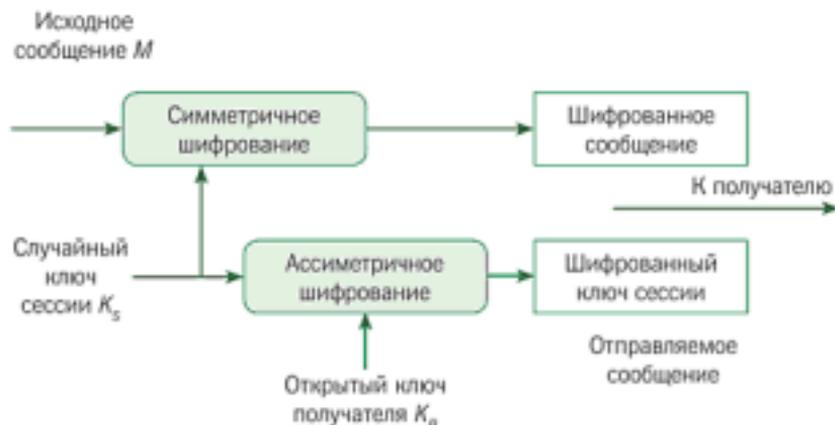
Рис. 6.3. Схема шифрования сообщения комбинированным методом
