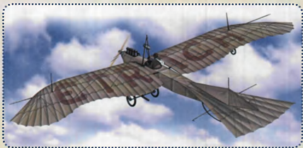
Igo Etrixning «Taube» samolyoti kabutar qanotlari shakliga ega bo'lgan
