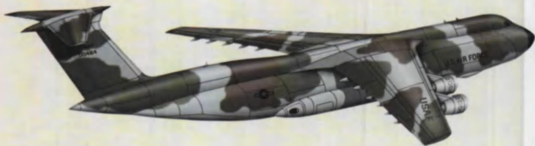
Amerikaning ulkan «Geleksi» samolyoti to'rtta ikki konturli tejamli reaktiv dvigatellar bilan jihozlangan
