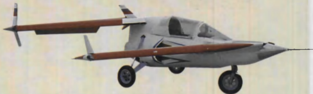
«Aviyetka» samolyotida – tandem sxemasi qo'llanilgan
