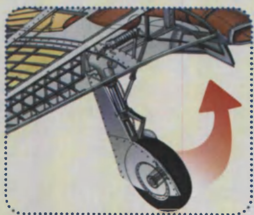
Yak-3 qiruvchi samolyotining yig'iladigan shassisi
