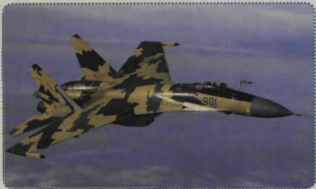
Rossiyaning Su-35 qiruvchi samolyoti «bo'ylama triplan»sxemasiga ega
