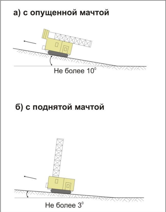
Рис. 1. Передвижение буровой установки самоходом
