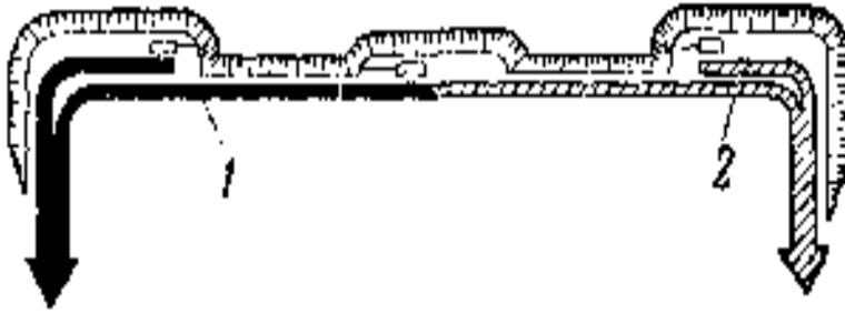
Рис. 34.4. Схема грузопотоков с уступа: 1 - вскрышных пород; 2- полезного ископаемого.
