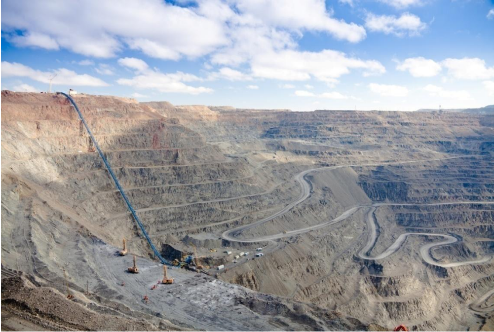
12.4. Rasm. Karerda yuk ko'taruvchi konveyrni qo'llash.
