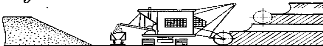
1-rasm. VO va VTR mashina komplekslari sifatida qo'llaniladigan bitta rotorli ekskavator qo'llaniladigan kompleksning texnologik sxemasi.
