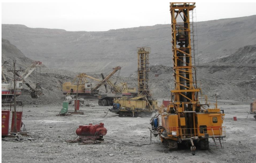
8.1. Rasm. Karerlarda sharoshkali burg‘ulovchi stanok yordamida skvajinalarni burg‘ulash.
