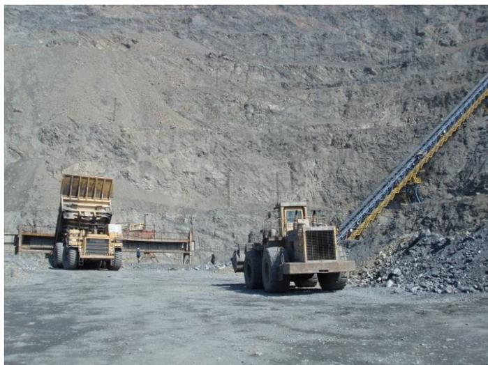
**Рис. 9.3. Совместная работа погрузчика САТ-992 и автосамосвала САТ-785В на рабочей площадке ДПП КНК-270**
