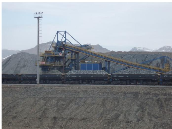
**Рис. 9.4. Погрузка руды в думпкары ПШС-3500 на перегрузочно-складском комплексе КНК-270**
