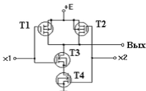
Рисунок 1.6 - Электрическая схема логического элемента КМОП-типа 2И-НЕ на транзисторах с индуцированными каналами n (Т3, Т4)- и p (Т1, Т2)-типа
