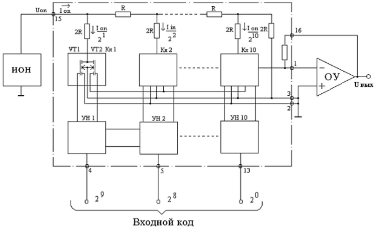
Рисунок 7.3 – Функциональная электрическая схема ЦАП типа К572ПА1 (А-Г)
