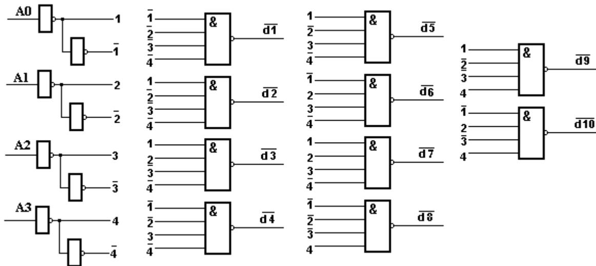
Рисунок 2.3 – Функциональная схема линейного двоично-десятичного дешифратора SN7445
