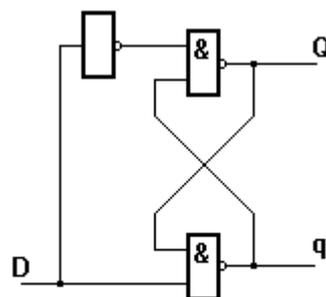
Рисунок 3.3 - Асинхронный D-триггер
