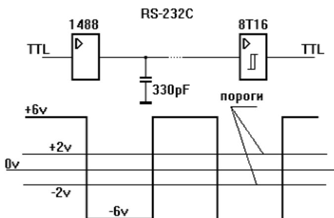
Рисунок 6.4 – Шина стандарта RS – 232C и временная диаграмма сигналов шины
