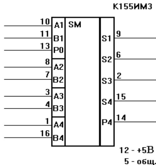
Рисунок 2.10 – Условно - графическое обозначение четырехразрядного сумматора К155ИМ3
