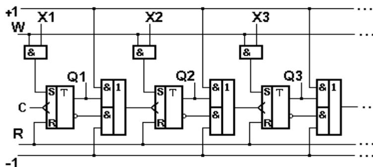
Рисунок 3.21 – Универсальный четырехразрядный последовательный счетчик с параллельной записью информации
