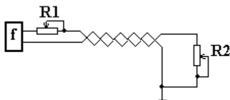
Рисунок 6.9 – Схема измерения волнового сопротивления длинной линии, согласованной в начале и конце линии
