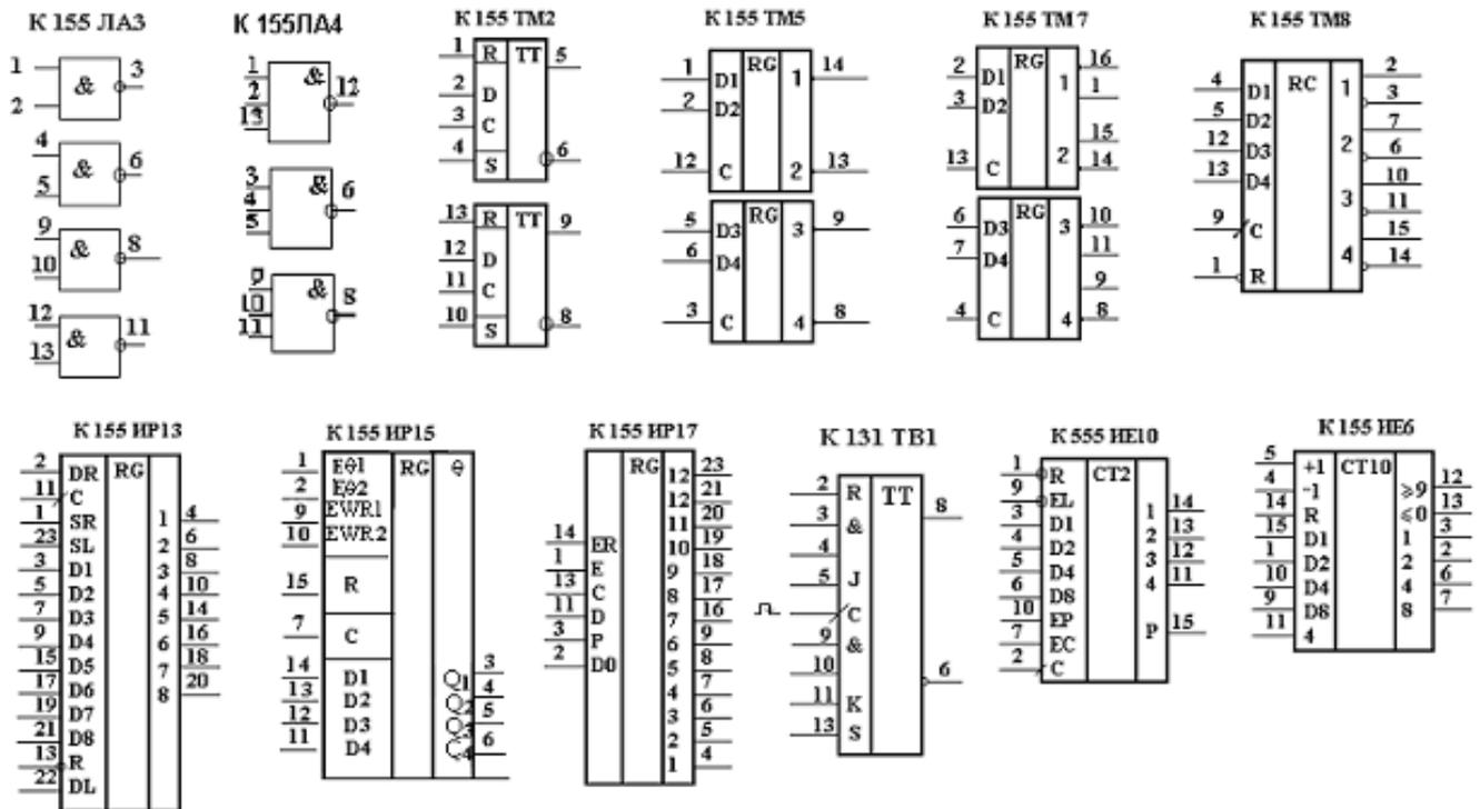
Рисунок 3.23 – Условно – графические обозначения тестируемых ИС
