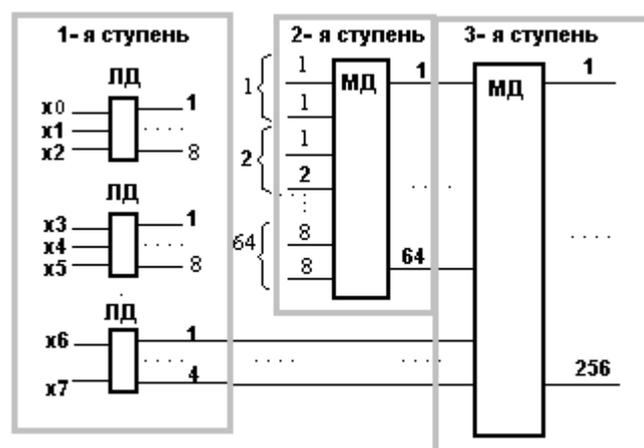
Рисунок 2.4 – Структурная схема прямоугольного матричного дешифратора
