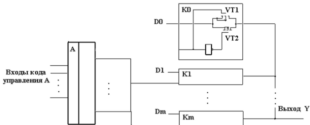
Рисунок 2.8 – Структурная схема мультиплексора с ключами на КМОП транзисторах
