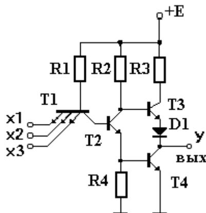
Рисунок 1.4 - Электрическая схема TTL-элемента 3И-НЕ с повторителем
