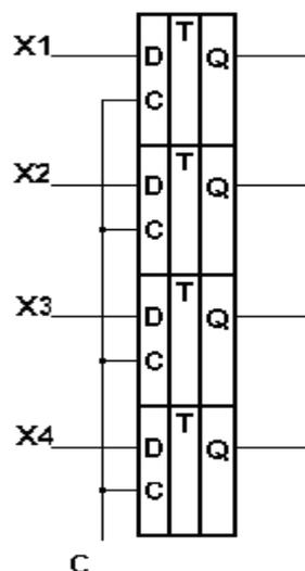
Рисунок 3.12 – Функциональная схема однофазного параллельного регистра
