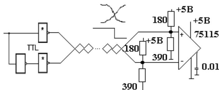
Рисунок 6.6 – Симметричная линия с дифференциальным приемником
