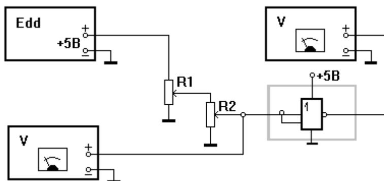
Рисунок 1.8 - Схема для измерения статической передаточной характеристики
