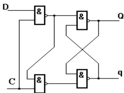
Рисунок 3.4-Синхронный D-триггер
