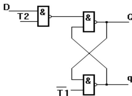
Рисунок 3.5- Двухтактный D-триггер
