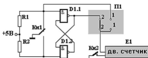
Рисунок 6.1 – Схема ввода данных с защитой от "дребезга"
