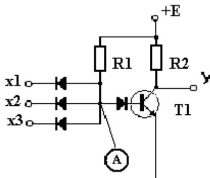
Рисунок 1.2 - Электрическая схема DTL - элемента И-НЕ
