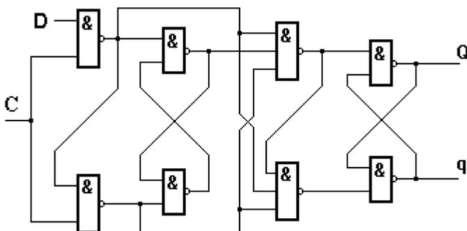
Рисунок 3.10 – Синхронный двухступенчатый D-триггер
