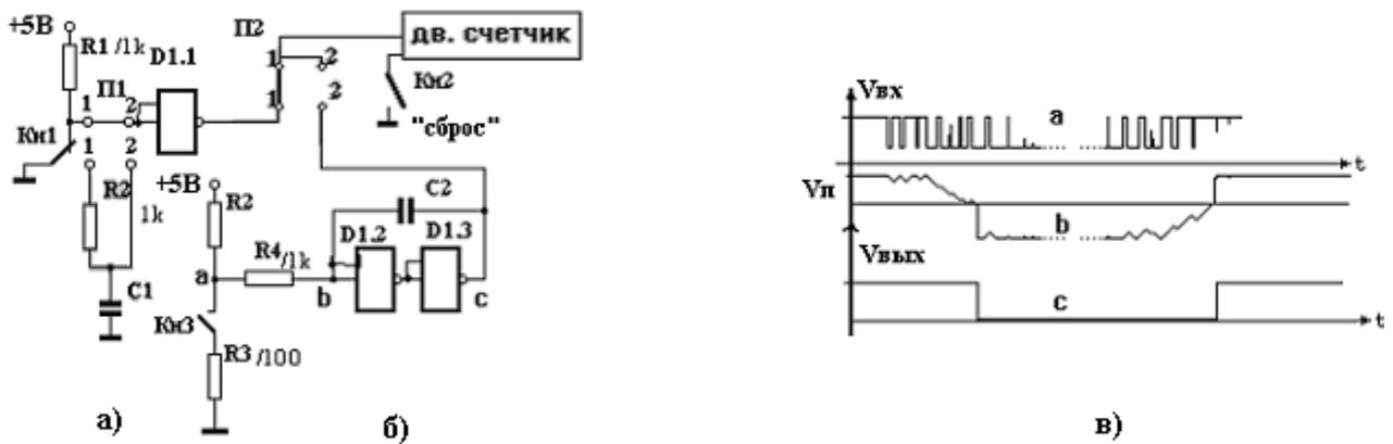
Рисунок 6.2 - Функциональные схемы ввода с защитой от "дребезга":
