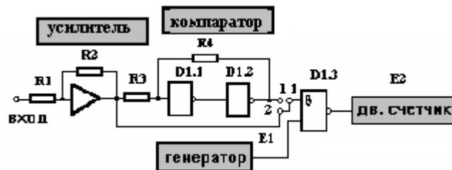
Рисунок 6.3 - Функциональные схемы ввода аналогового сигнала
