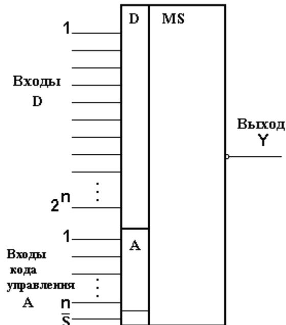
Рисунок 2.6 – Условно - графическое обозначение мультиплексора
