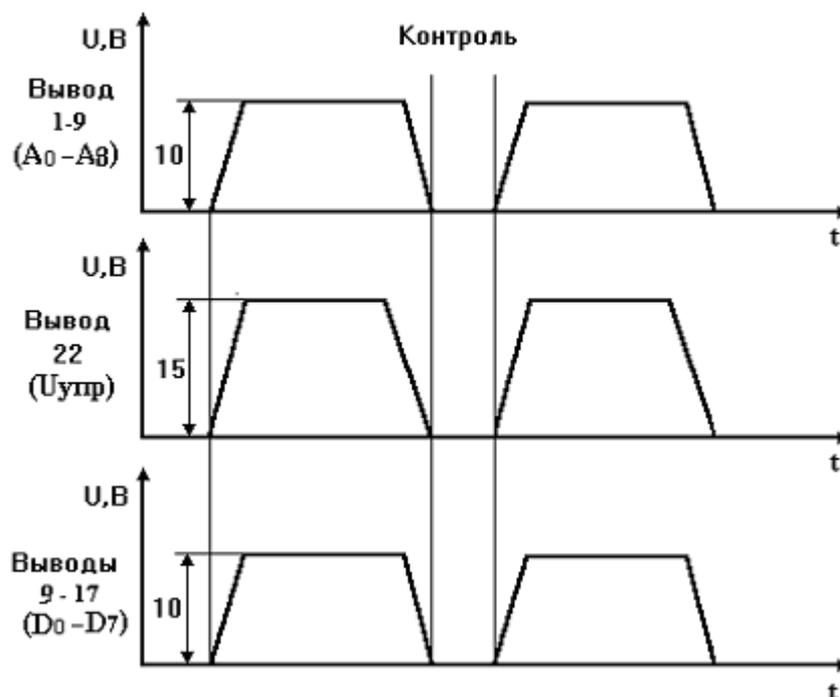
Рисунок 4.9 – Временные диаграммы программирования («прожигания») данных в ОПЗУ
