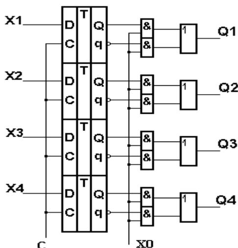
Рисунок 3.14. Регистр, преобразующий прямой код в обратный код
