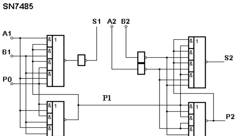
Рисунок 2.9 – Функциональная схема двухразрядного сумматора типа SN7482
