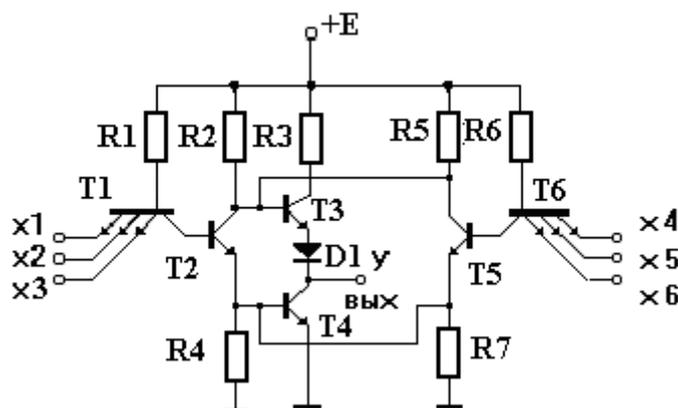
Рисунок 1.5 - Электрическая схема TTL - элемента типа 3И-ИЛИ – НЕ
