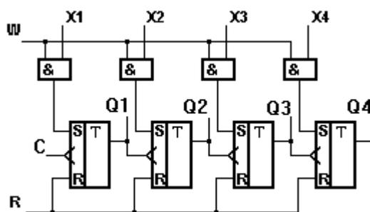
Рисунок 3.19 – Последовательный счетчик с параллельной записью информации
