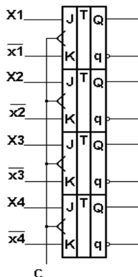
Рисунок 3.13 - Функциональная схема парафазного параллельного регистра
