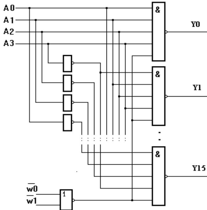
Рисунок 2.2 – Функциональная схема  $4^x$  входного линейного дешифратора
