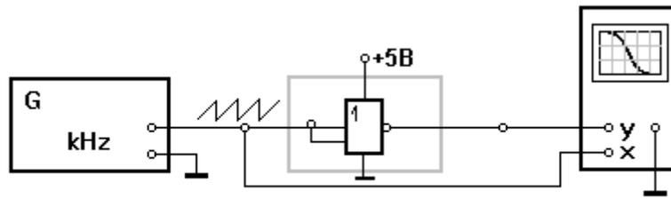
Рисунок 1.9 - Схема для измерения статической передаточной характеристики (способ 2)
