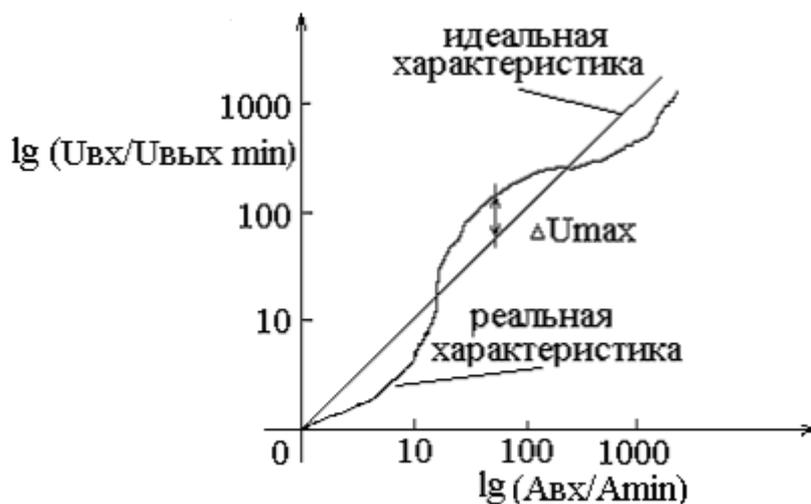
Рисунок 7.5 – Зависимость выходного напряжения ЦАП от входного кода в двойном логарифмическом масштабе
