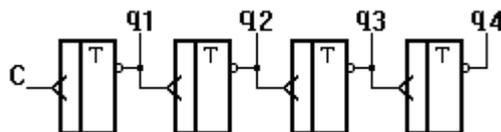
Рисунок 3.20 – Вычитающий счетчик
