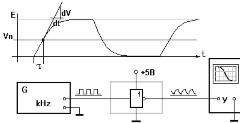
Рисунок 1.10 - Схема для измерения постоянных времени
