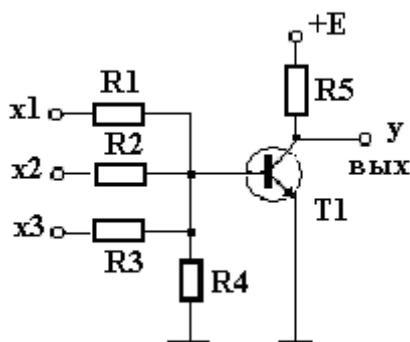
Рисунок 1.1 - Электрическая схема RTL - элемента ЗИЛИ-НЕ
