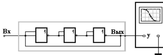
Рисунок 1.11 - Схема измерения среднего времени задержки распространения сигнала
