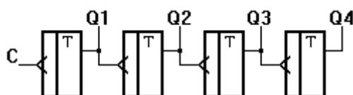
Рисунок 3.18 – Последовательный двоичный счетчик
