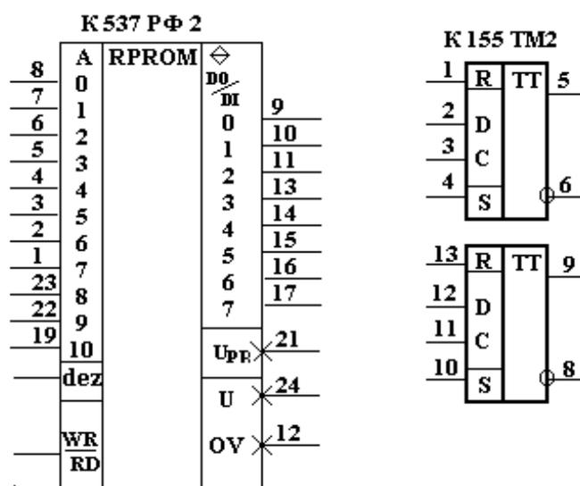
Рисунок 5.7 – Условно- графические и буквенно-цифровые обозначения ПЗУ и триггеров
