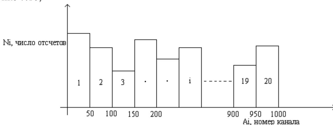
Рисунок 7.10 - Гистограмма распределения амплитуды пилообразного сигнала
