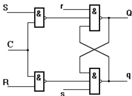
Рисунок 3.2 - Синхронный одноктактный RS-триггер
