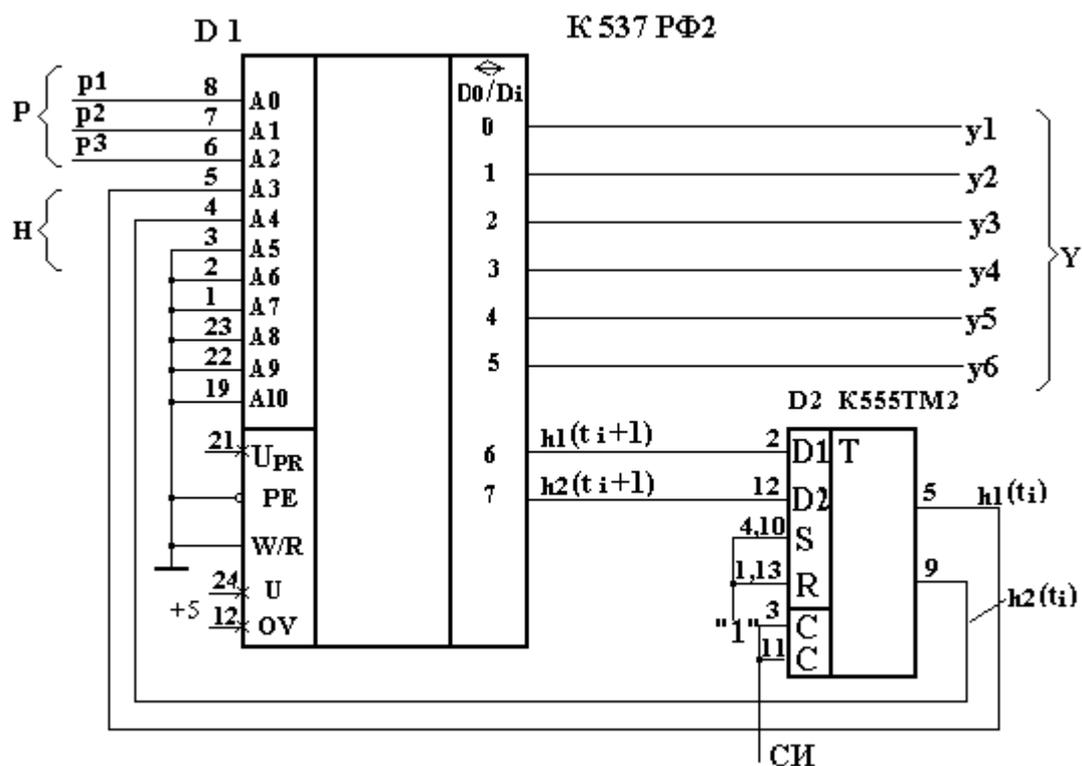
Рисунок 5.3 – Функциональная схема синтезируемого автомата Мили
