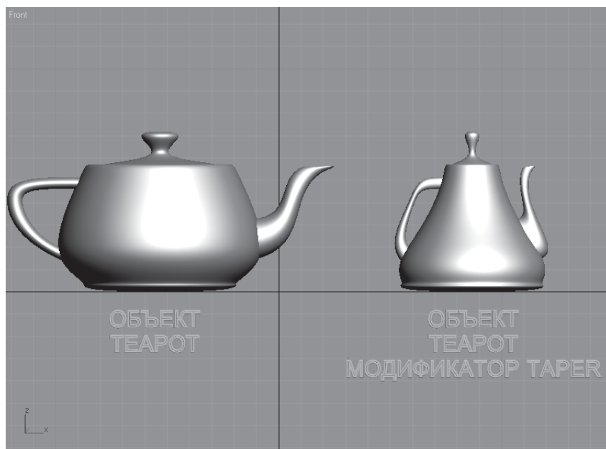
Рис. 1.45. Объект Teapot (Чайник) до (слева) и после (справа) применения модификатора Taper (Сужение)
