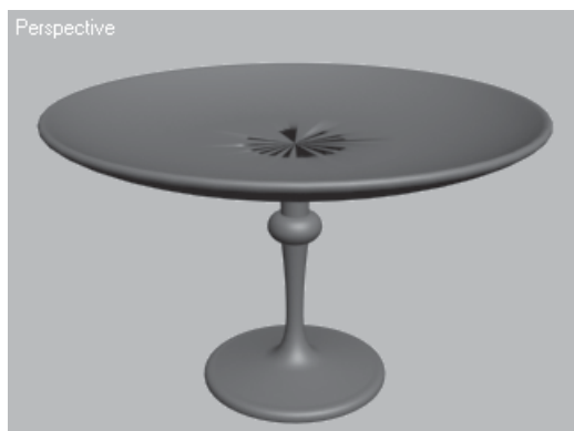
Рис. 2.31. Объект после применения модификатора Lathe (Вращение вокруг оси) и выполнения некоторых настроек
