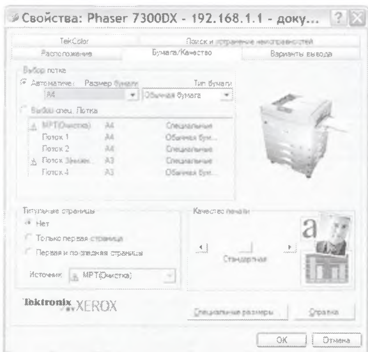
3.17.6-расм. Принтер хусусиятлари дарчасида қоғоз турини ва чоп қилиш сифатини белгилаш бўлими
