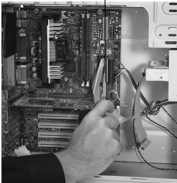
Рис. 22.22. Подключение устройств с интерфейсом ATA
