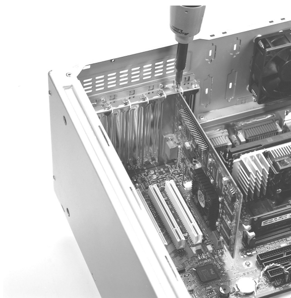
Рис. 22.28. Закрепление адаптера винтом
