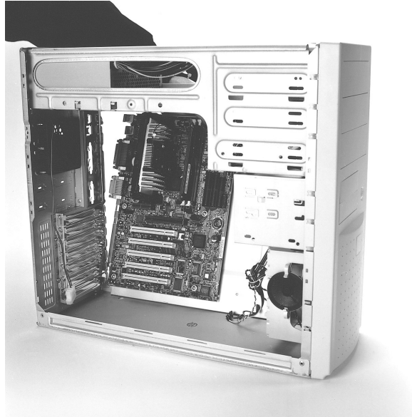
Рис. 22.15. Установка шасси с системной платой в корпус
