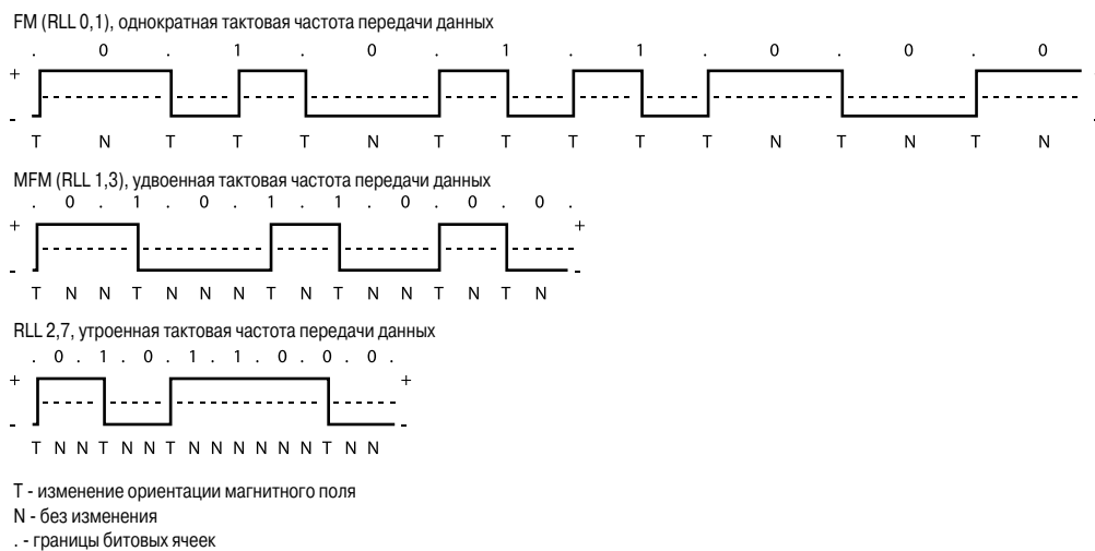
Рис. 9.8. Сигналы, формируемые во время записи ASCII-кода символа “X” при способах кодирования FM, MFM и RLL 2,7
