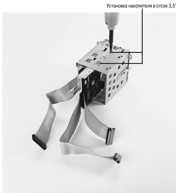
Рис. 22.25. Закрепите жесткий диск и дисковод в съемном отсеке с помощью винтов
