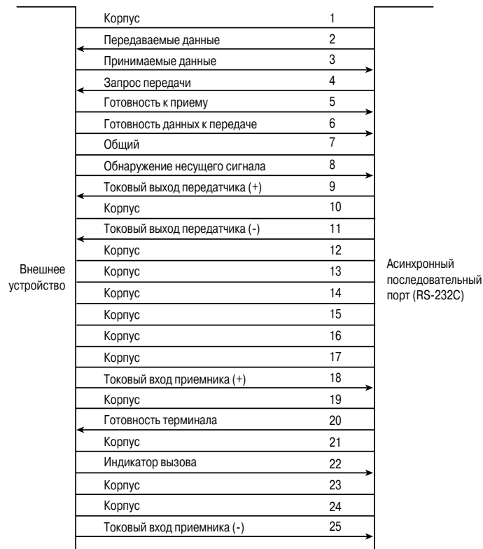
Рис. 17.9. Стандартный 25-контактный разъем последовательного порта
