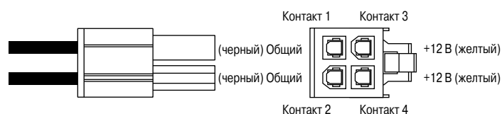
Рис. 21.8. Разъем питания ATX12V
