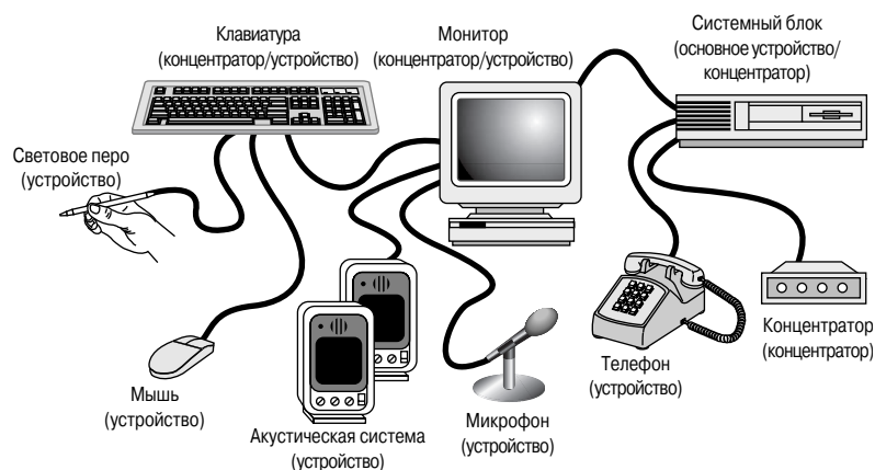
Рис. 17.3. В персональном компьютере может использоваться несколько концентраторов USB для подключения различных периферийных устройств, причем любое устройство можно подсоединить к любому концентратору
