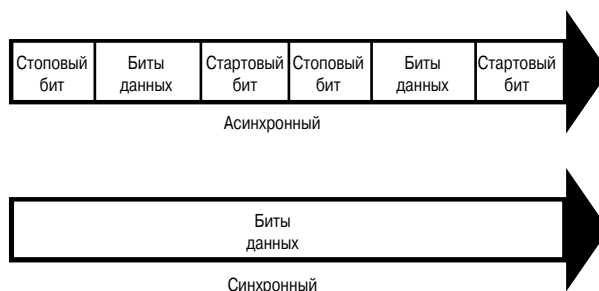
Рис. 19.9. В асинхронных модемах при передаче одного байта данных добавляются стартовые и стоповые биты, а в синхронном соединении данные передаются непрерывным потоком
