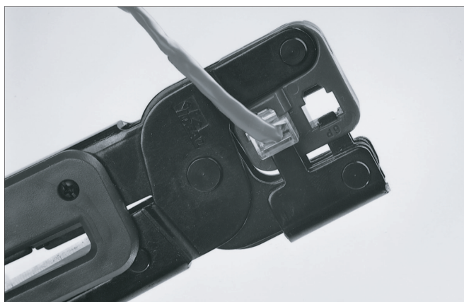
Рис. 20.21. Хорошо сожмите насадочный инструмент, чтобы плотно прикрепить разъем к кабелю
