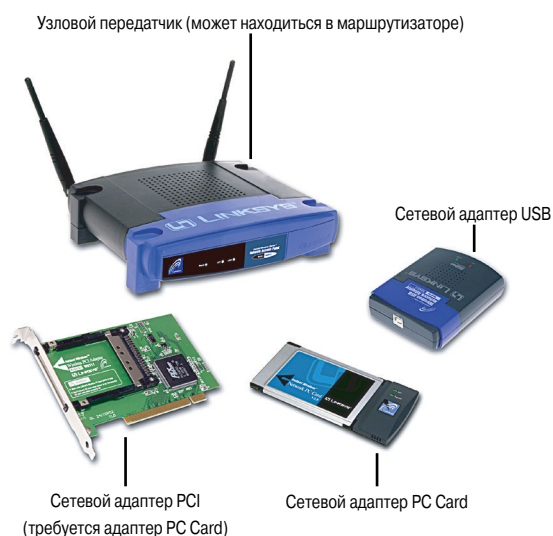
Рис. 20.23. Традиционное семейство продуктов стандарта Wi-Fi включает в себя беспроводной узловой передатчик и сетевые адаптеры USB/PC Card/PCI. Адаптер PC Card используется в портативных компьютерах, не имеющих встроенной поддержки Wi-Fi, а также применяется в качестве приемопередатчика для PCI-адаптеров настольных систем
