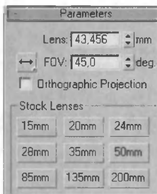
86-rasm. Kameraning ko'rish maydoni va fokus masofasi parametrlarini o'rnatish.
