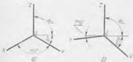
118-шакл. Тўғри бурчакли аксонометрик ўқлар вазияти
