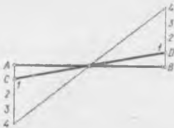
66- шакл. Ўткир бурчак остида кесишу ви чизиқлар нуқтасини аниқлаш
