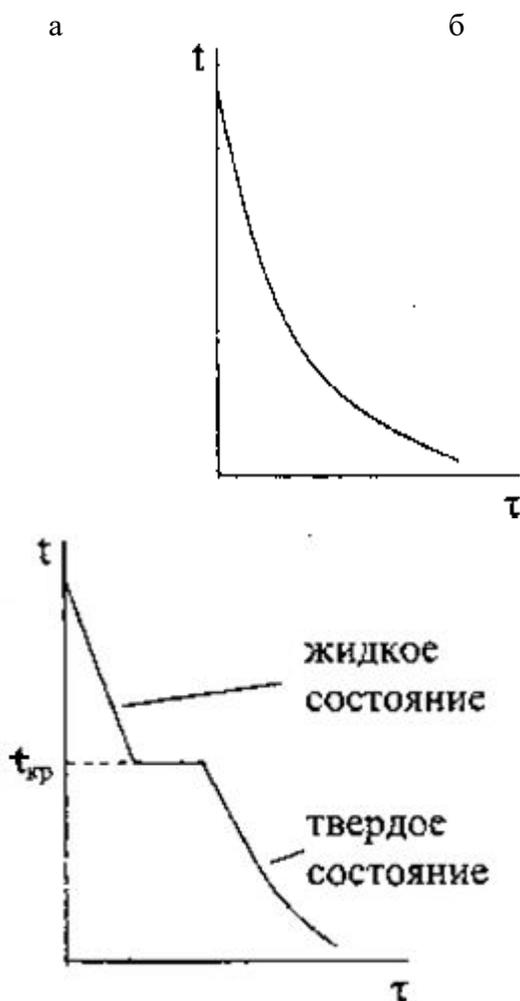
Рис. 1.2. Кривые охлаждения аморфного и кристаллического тел
