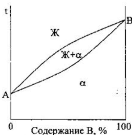
Рис. 1.9. Диаграмма состояния сплавов с неограниченной растворимостью
