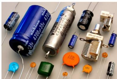
Рис. 4. Типы конденсаторов
