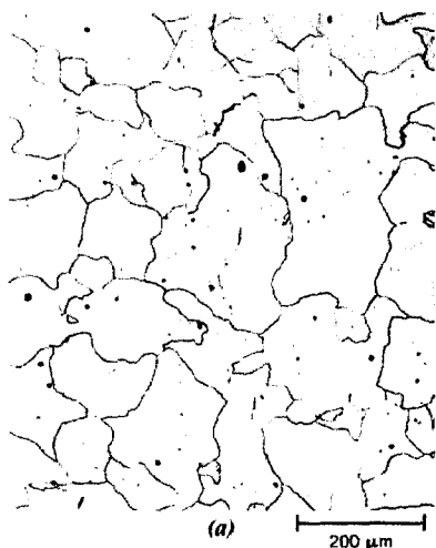
3.3-rasm. Ferrit (a) va austenit (b) mikrostrukturalarining kattalashtirilgan tasvirlari.
