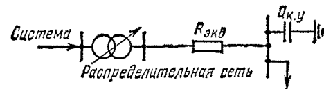
Рис. 10.5.1. Схема замены распределительной сети эквивалентными сопротивлениями R_{\text{эkv}}
