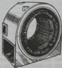
Рис. 8.10. Литая станина с впрессованным магнитопроводом
