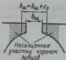
Рис. 9.60. Насыщение участков коронок зубцов потоком рассеяния
