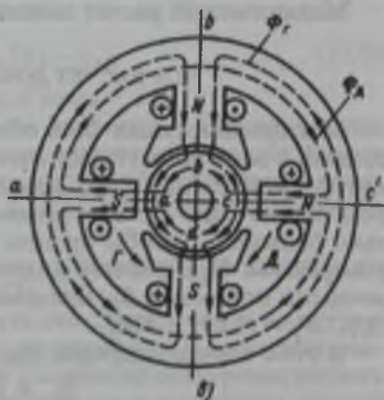
Рис. 11.27. К расчету магнитной цепи добавочных полюсов:
