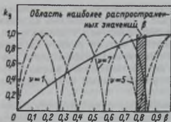
Рис. 3.12. Изменение коэффициента укорочения для различных гармоник в зависимости от \beta
