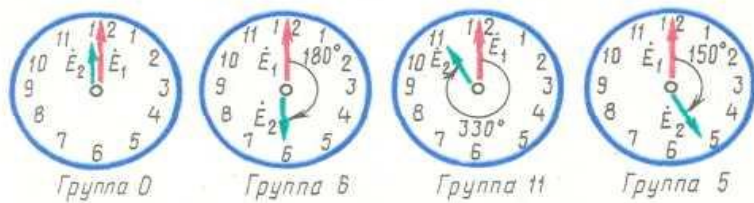
Рис. 10.2. Сравнение положения стрелок часов с обозначением групп соединения.
