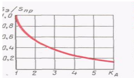
Рис.13.2. Зависимость S_3/S_{пр} от коэффициента трансформации автотрансформатора
