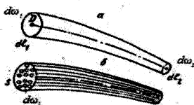
3.2- rasm. Oqim naychasi. elementar oqimcha va oqim.
