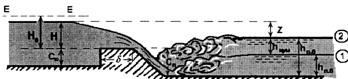
16.22-rasm - Amaliy profilli suv o'tkazgich sxemasi.
