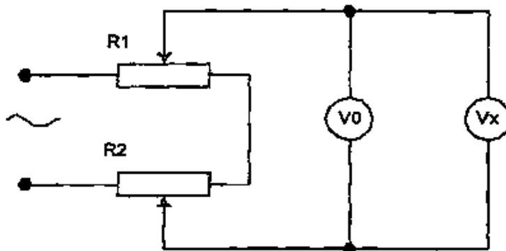
Рис. 6 Проверка вольтметра
