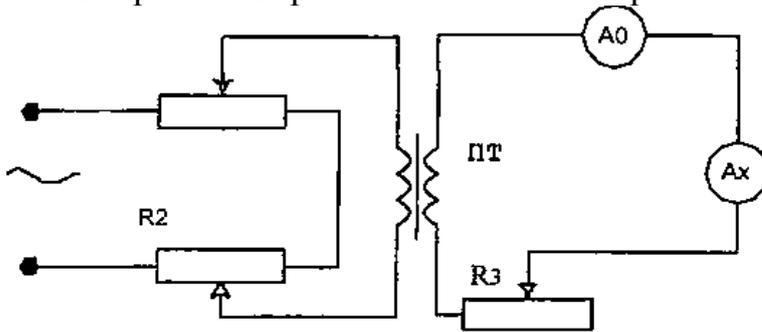
Рис. 8 Поверка амперметра
