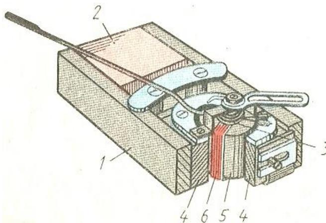
силы тока и напряжения в цепях постоянного тока. Прибор состоит из постоянного магнита подковообразной формы и подвижной рамки (2) с несколькими витками изолированной проволоки. К оси рамки прикреплена стрелка I. При прохождении тока рамка поворачивается на определенный угол, зависящий от величины тока.
