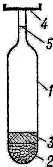
5.5-расм. Доимий ҳажмли ареометр. 1-ғилоф; 2-балласт; 3-боғловчи модда; 4-торози тоши учун идиш; 5-белги.
