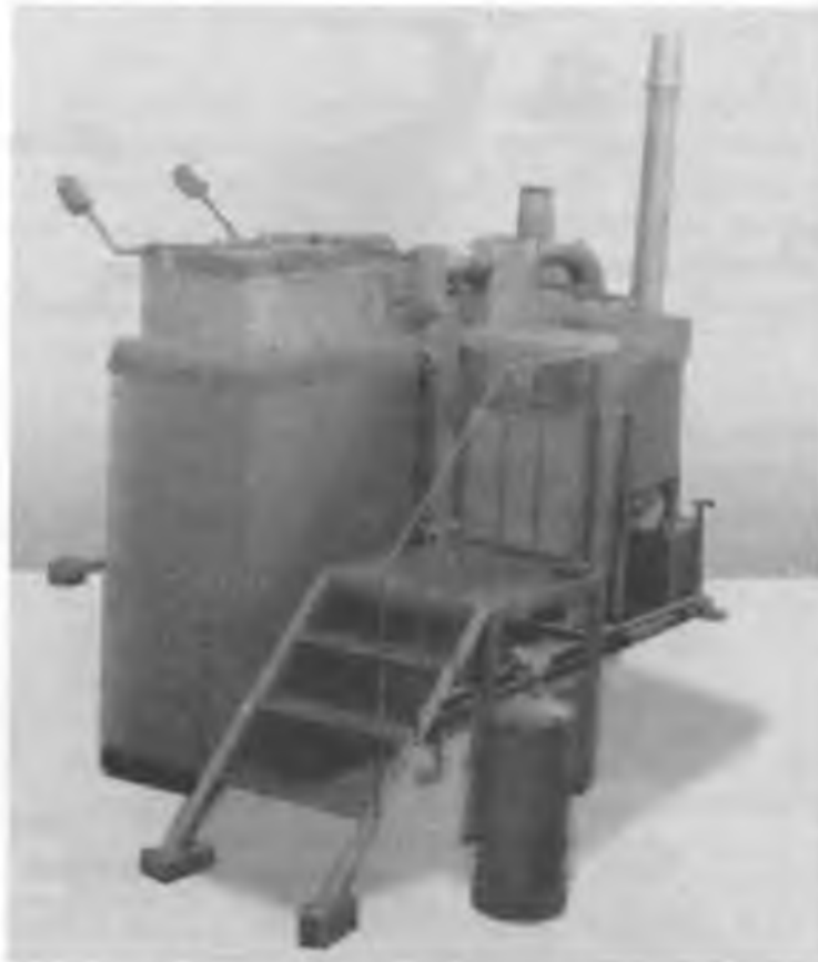
Рис. 18. Установка для экологически чистого уничтожения твердых отходов ЭЧУТО-150.02 (г. Переславль-Залесский)
