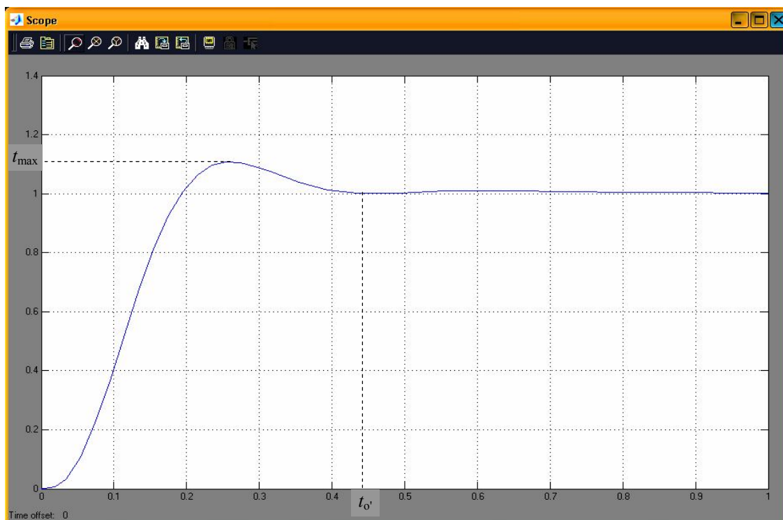
5.14-rasm. Korrektlangan sistemaning birlik pog‘onali kirish ta’siridagi o‘tkinchi jarayoni grafigi.
