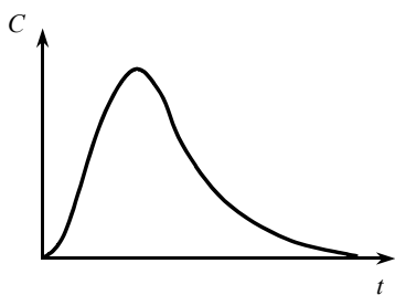
Рис. 3.1 Типичная функция отклика аппарата на импульсное возмущение
