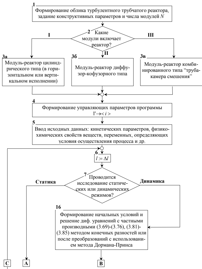
Рис. 3.23 Блок-схема алгоритма расчета статических и динамических режимов процессов диазотирования и азосочетания, осуществляемых в турбулентных реакторах трубчатого типа: (3.69) – (3.76), (3.81) – (3.85)
