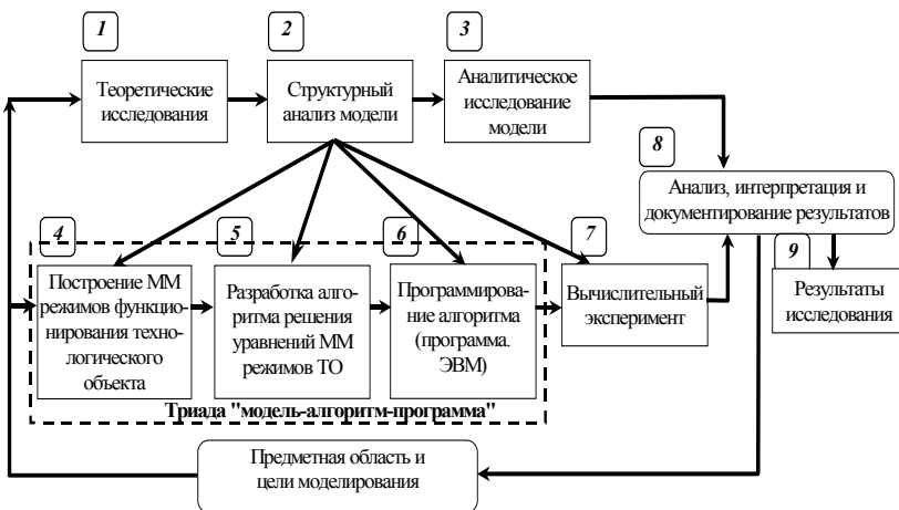
Рис. 1.1 Схема организации процесса компьютерного моделирования
