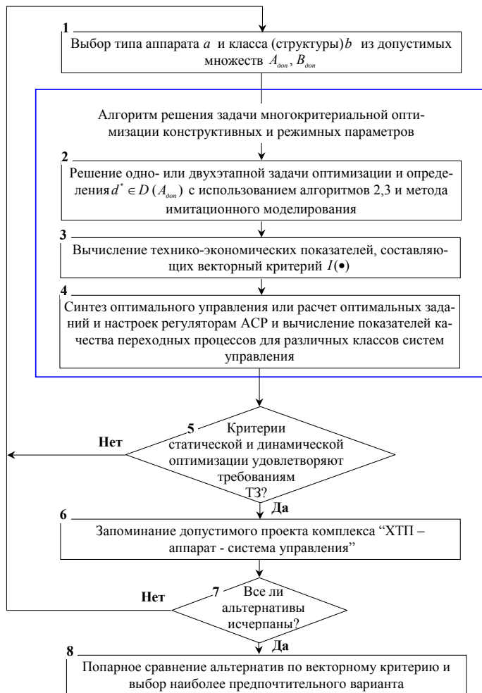
Рис. 4.6 Итерационная процедура многокритериальной оптимизации комплекса "ХТП – аппарат – система управления"
