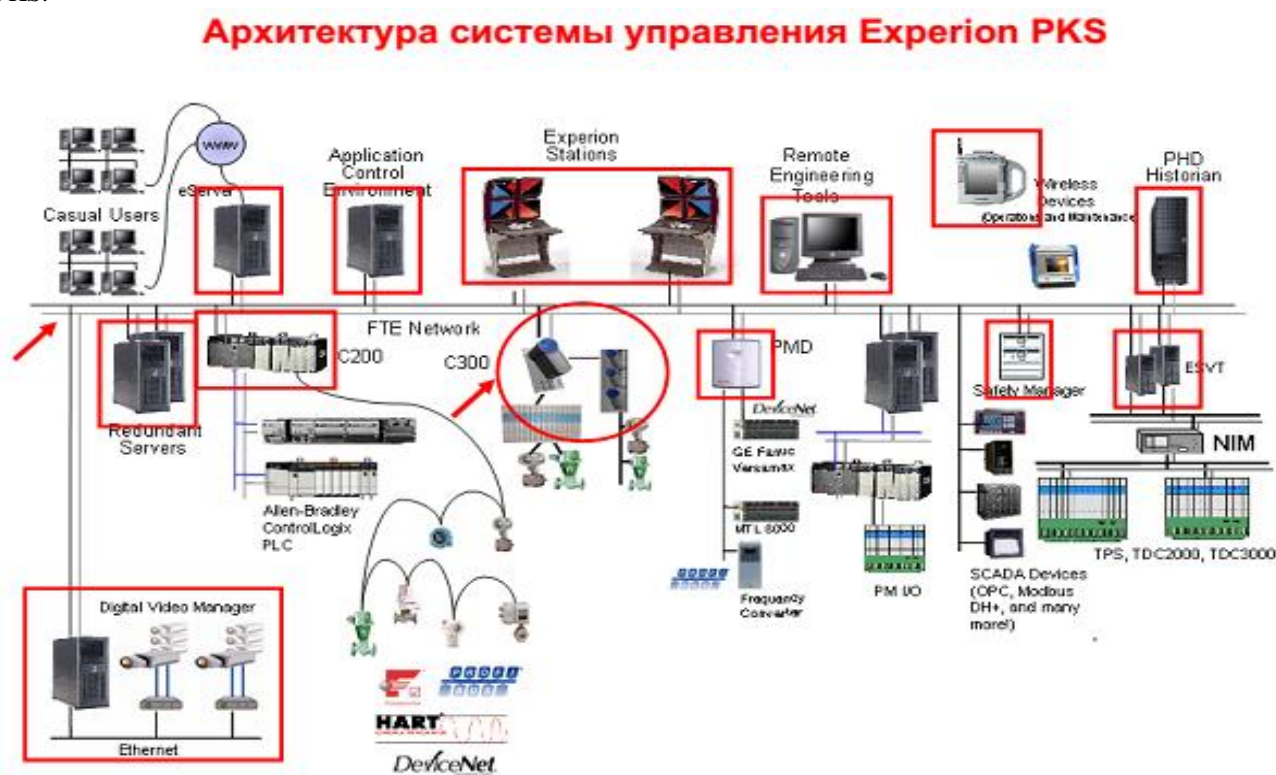
Рис. 1 Архитектура системы управления Experion PKS
