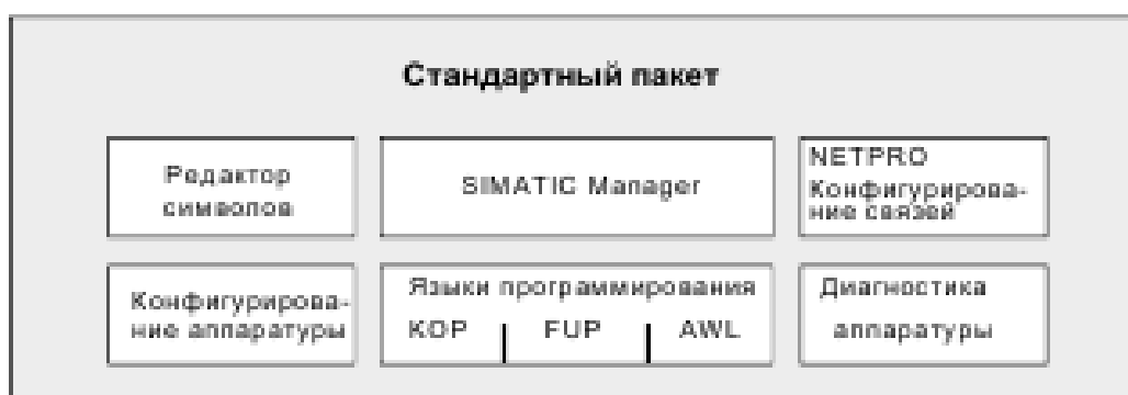
Рис. 2. Состав стандартного пакета STEP 7
