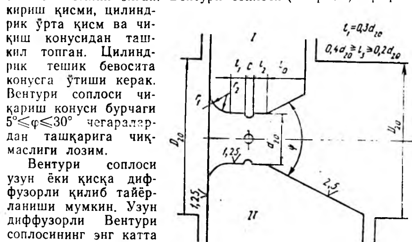
4.4- расм. m = 0.444 шарт учун қисқа ва узун Вентури соплоси.
