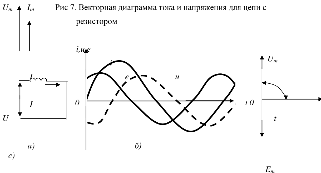
Рис 8. Электрическая цепь с катушкой индуктивности: а) схема, б) графики тока, напряжения и эдс самоиндукции. с) векторная диаграмма.
