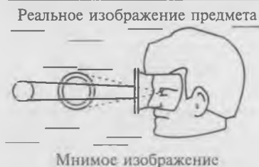
Рис. 6.1. Схема преломления световых лучей глазом человека
