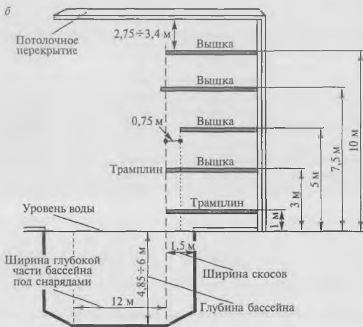
Рис. 1.6. Схема бассейна с полным профилем снарядов для прыжков в воду: a — вид спереди, б — вид сбоку
