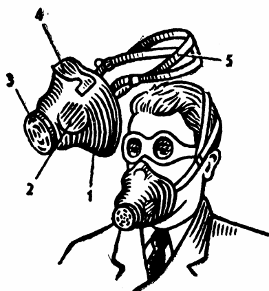
3-rasm. Resperator R-2: 1-yarim niqob; 2-nafas oluvchi klapan; 3-nafas chiqaruvchi klapan; 4-burun qisqichi; 5-tasmalar.
