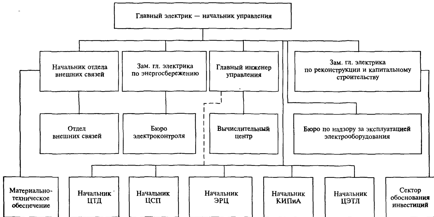
Рис. 21.2. Организационная структура управления главного электрика (УГЭл): ЦТД — цех технологической диспетчеризации; ЦСП — цех сетей и подстанций; ЭРЦ — электроремонтный цех; КИПиА — цех контрольно-измерительных приборов и автоматизации; ЦЭТЛ — центральная электротехническая лаборатория
