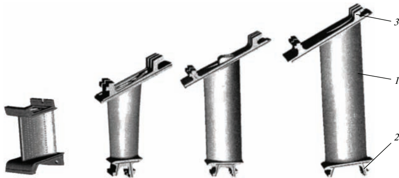
Рис. 13.16. Сопловые лопатки газовой турбины ГТУ V94.3A фирмы «Сименс»:
