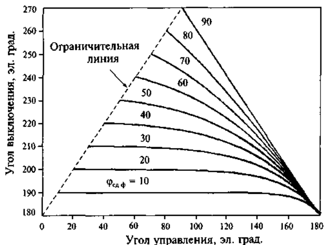
Рис. 6.4. Зависимости угла выключения тиристора от угла управления и угла сдвига фаз ( \varphi_{сл\ \phi} ) нагрузки
