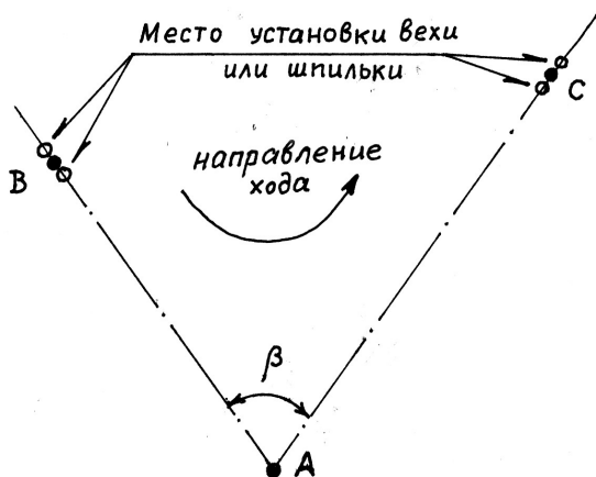
Рис. 7.22. Установка вех и шпилек при измерении горизонтальных углов
